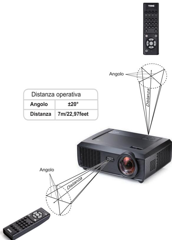
**NOTA:** La distanza operativa attuale potrebbe differire leggermente da quella dell'illustrazione. Le batterie scariche impediscono inoltre al telecomando di azionare correttamente il proiettore.
